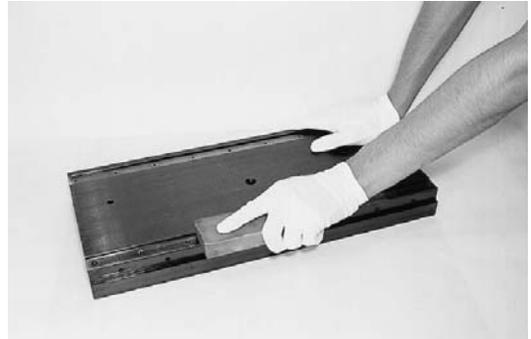
有必要对机器安装基面进行精度测量，因此需要用到一些适当的测量仪器。
